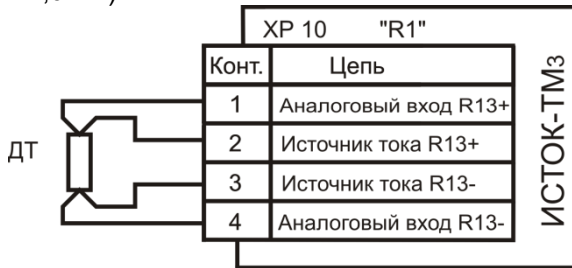
Рисунок 1.4 – Пример подключения ДТ к ИБх «13» вычислителя
